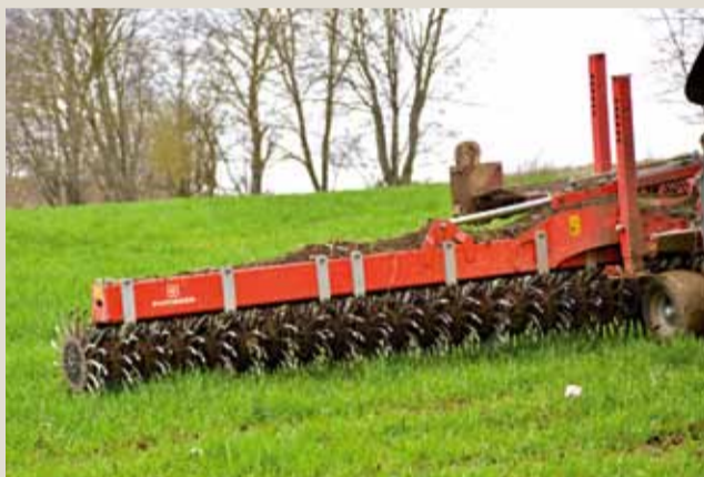
Rotačná plečka Pöttinger Rotocare s pracovným záberom 8 metrov, v súprave s traktorom s výkonom 120 koní.
