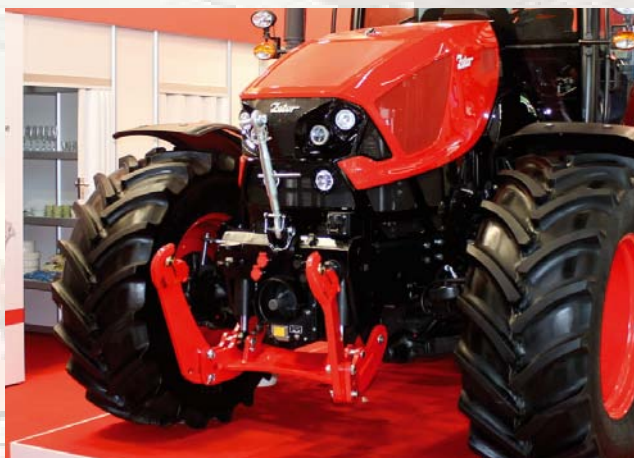
Predný TBZ od firmy Zuidberg bude disponovať nosnosťou 2800 kg.
