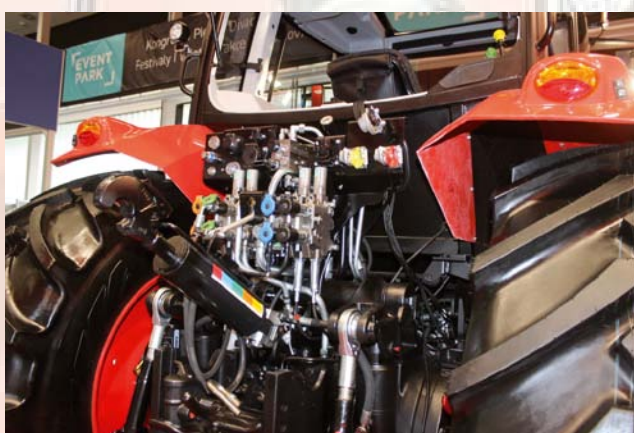
V štandarde budú použité štyri vonkajšie okruhy hydrauliky s mechanickým ovládaním (tretí a štvrtý okruh s mechanickou reguláciou prietoku).
