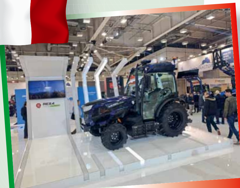
Landini REX4 vo verzii FULL HYBRID, ktorý umožňuje až 2 hodiny čisto "elektrickej" práce s odpojeným dieselovým motorom.
