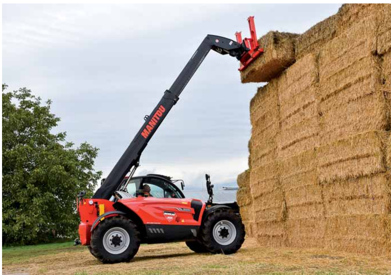
Pri ukladaní balíkov oceníte funkciu Quicklift, keď sa výložník pohybuje zvislo a nie ako bežne po kružnici.
