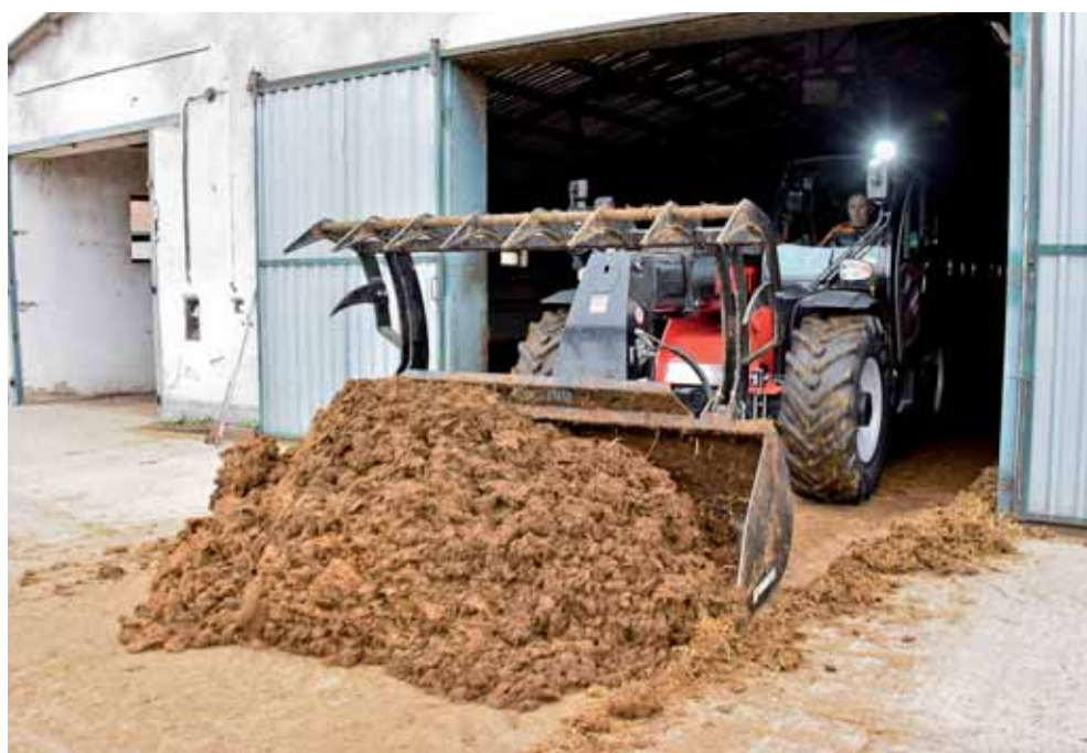
Lýžica s pridržiavačom nesmie v hnoji chýbať. Aj keď je na stroji manuálne istenie náradia, Manitou prostredníctvom Moreau Agri vie dodať aj hydraulické istenie.
