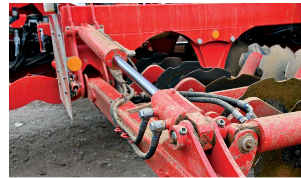
Pre výborné kopírovanie povrchu a zachovanie totožnej hĺbky obrábania je Terrasem vybavená dvojitým hydraulickým valcom. Zabezpečuje kopírovanie aj „pod terén“ a naopak na svahu sekciu priláčajú piesty pomocou dusíkového akumulátora.
