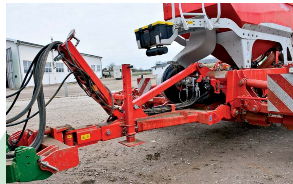
Teleskopicky vysívateľné oje je výhodné v prípade dvojmontáží, nasávanie pre ventilátor posunul Pöttinger vyššie z dôvodu nižšej prašnosti.
