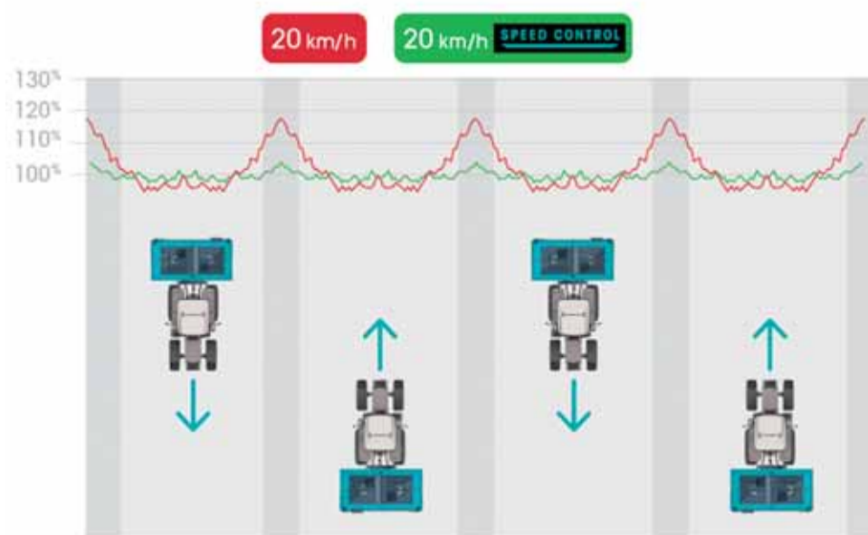
Rozhadzovač s aktivovaným systémom SPEED CONTROL.
