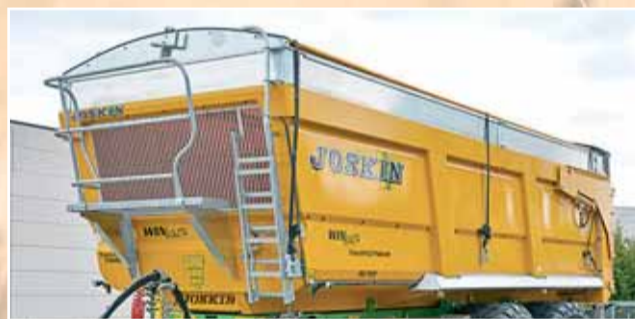
Plachta návesu s prístupovým rebríkom a plošinou.
