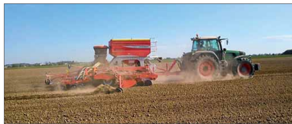
Univerzálny sejací stroj Pöttinger Terrasem C6 agregujú s traktorom s výkonom 300 koní.
