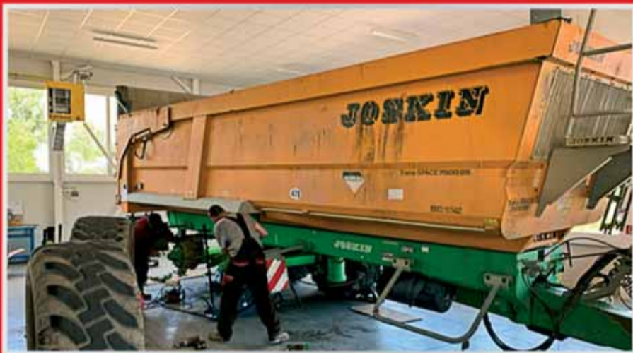
Demontáž nápravy na Joskine TransSpace.
