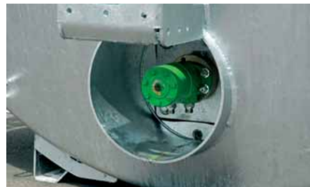
Miešanie na dne cisterny s hydraulickým náhonom.
