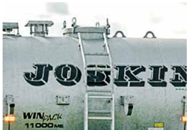
Horný otvor Ø 600 mm.
