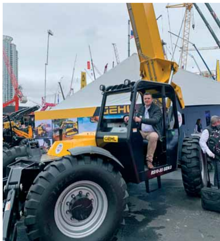
Teleskopické manipulátory predáva Manitou v USA aj pod značkov Gehl. Na fotke vidíme typické prevedenie pre americký trh. Otvorená kabína, žiadne kúrenie alebo klimatizácia, jednoduché ovládacie páky – maximálna jednoduchosť pri maximálnej funkčnosti. Označenie manipulátora je RS 10-55, čo znamená maximálnu nosnosť 10 000 libier (cca 4500 kg) a dosah 55 stôp (16,8 m).
