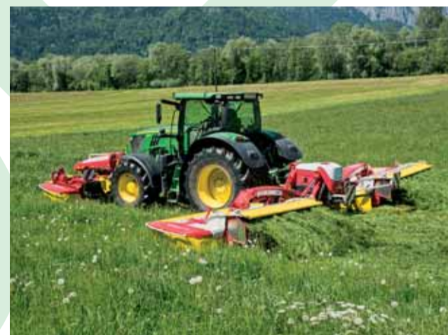
NOVACAT A 10 – nastaviteľný pracovný záber i v priebehu práce.
