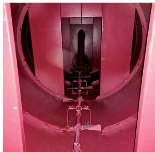
Vnútorná úprava povrchu pre používanie agresívnych dusíkatých látok.
