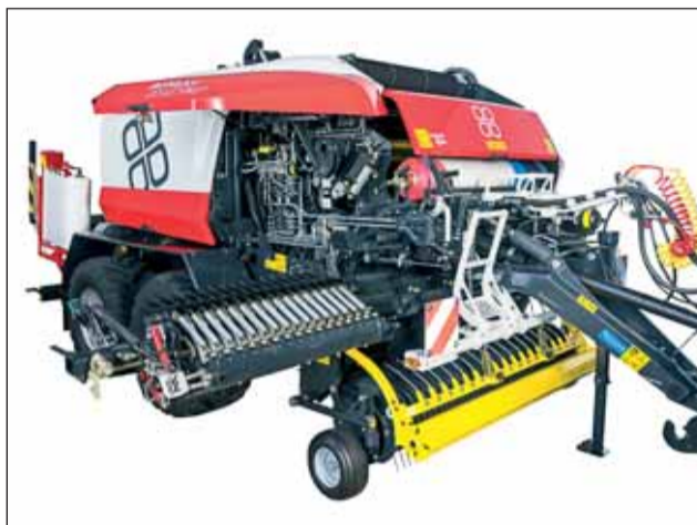
Výkyvný nosník nožov EASY MOVE pre dokonalú, bezpečnú a rýchlu údržbu.
