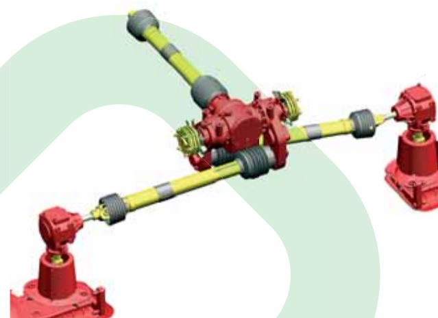
Pohon žacích líšt cez Y DRIVE prevodovky - pokojný a tichší chod s cieľom vyššej výkonnosti a dlhšej životnosti.
