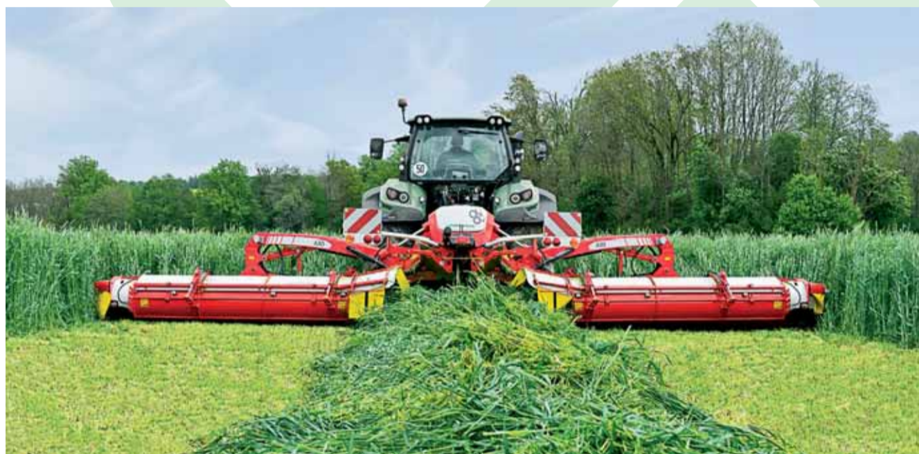
NOVACAT A 10 CF – žacia kombinácia vybavená dopravnými závitovkami pre jednoduché ukladanie materiálu na riadok s cieľom vysokej a čistej kvality krmiva.
