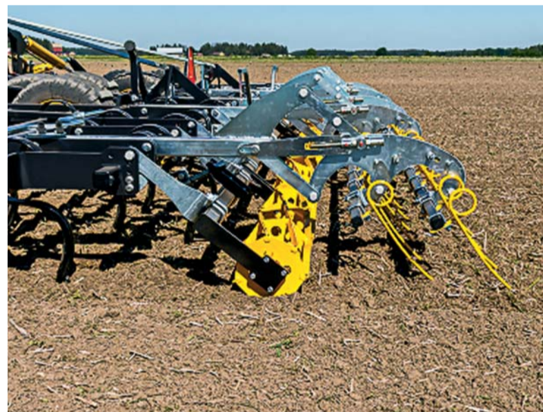
Vo verzii Topline Cross alebo Topline super XL je možné na želanie stroj osadiť dvojradvými prstovými bránami.
