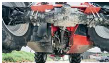
Pri pohľade pod stroj je voľný výhľad na prevodovku a hnacie časti. Pre ťažšie podmienky si viete objednať ochrannú platňu.
