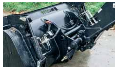
Doterajší rýchlovýmenný systém pre náradie je dobrý, s manuálnym istením strátiť viacej času.
