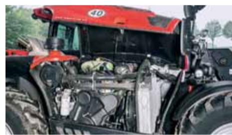
Prístupnosť k motoru Deutz je napriek obmedzenému priestoru v poriadku. Manitou ako sériovú výbavu montuje reverzný ventilátor.
