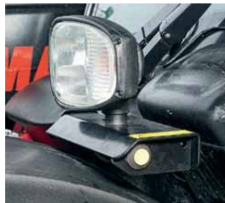
Pri pripájaní a odpájaní hydraulicky ovládaného náradia treba stlačiť toto tlačidlo na odtlakovanie hydrauliky.
