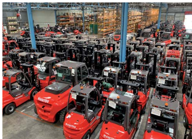
VZV Manitou pripravené pre zákazníkov. Záberu v popredí dominuje MI 100D, VZV Manitou s nosnosťou 10 ton.
