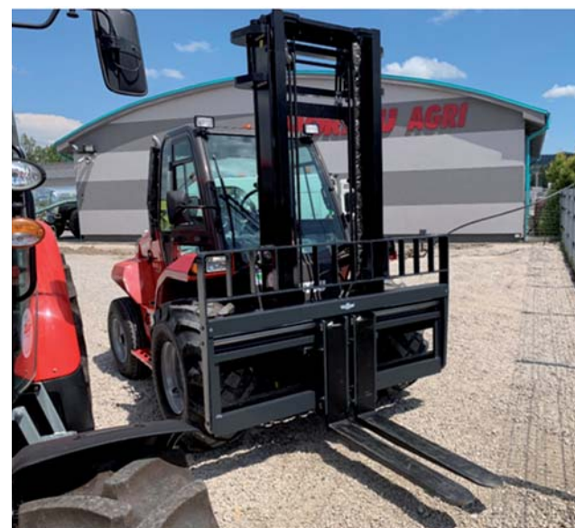
Výrobok z Beaupreau sme mali pred pár dňami aj v Maduniciach. Manitou M40-2 sme dodávali s hydraulickým pozicionérom vidiel Cascade so šírkou 2m.
