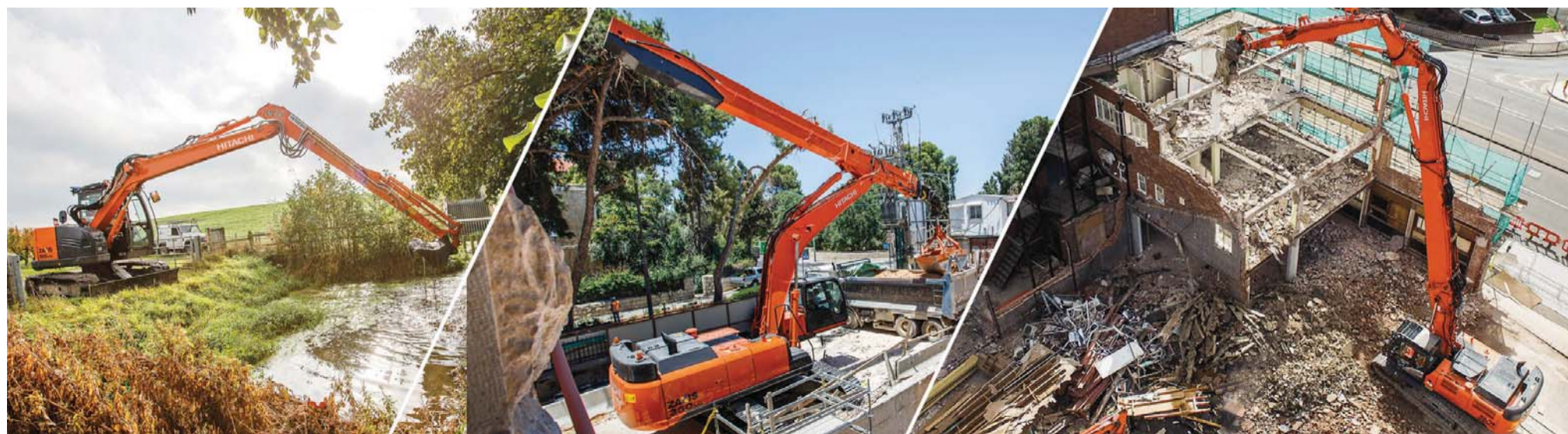
Rýpadlo so superdlhým ramenom Hitachi ZX85US-5, rýpadlo Hitachi ZX350LC-6 s teleskopickým ramenom a v prevedení s demolačnou hlavicou.
