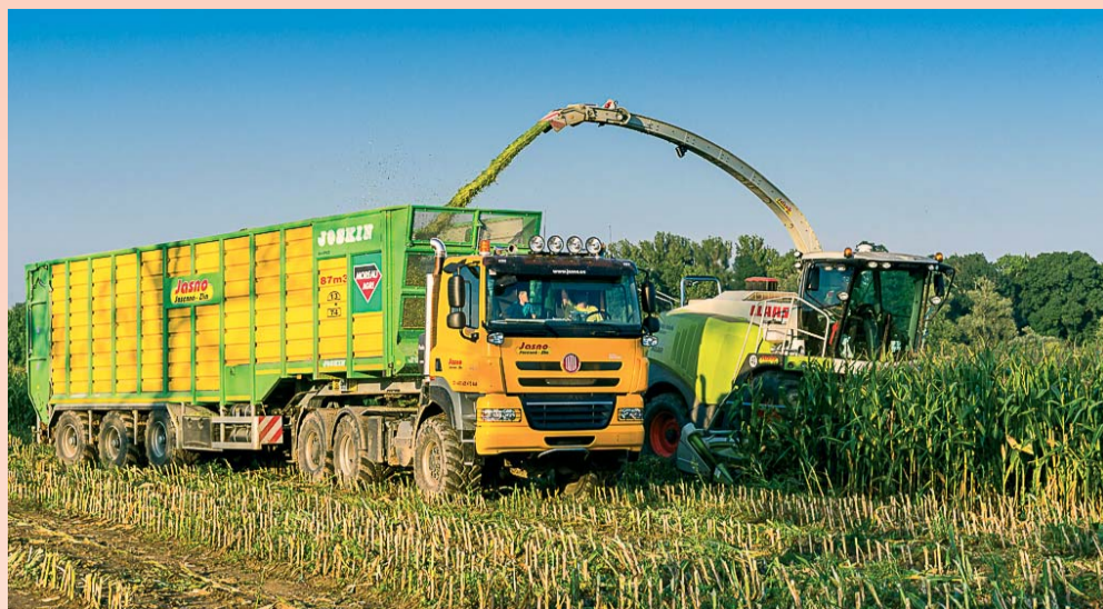
Unikátne spojenie: ťahač TATRA so 460 HP motorom a JOSKIN SiloSPACE = 87 m 3 siláže na jeden prejazd.
