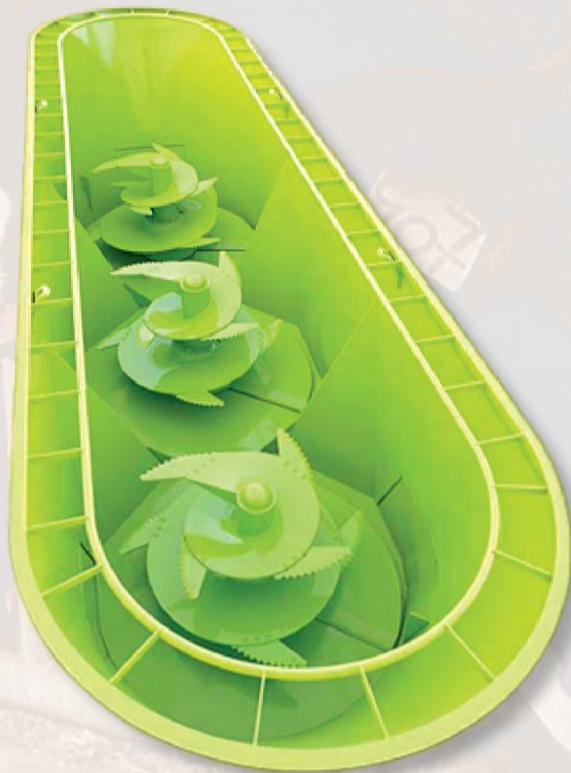
Pohľad do korby krmného voza s vertikálnym miešaním
