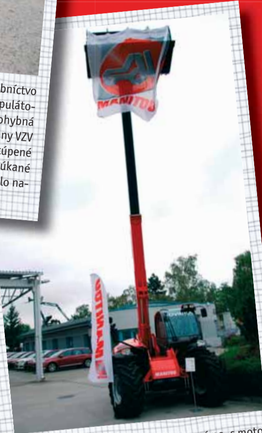
Najnovší prírastok radu MLT, nosnosť 6 t, zdvih 9 m – MLT 960 vybavený varioprevodovkou na komplet novom ráme, s moto- rom John Deere.
