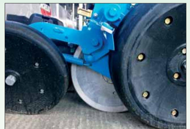
Utláčacie PRO koleso s priemerom 295 mm pre zlepšenie kontaktu osiva s pôdou.
