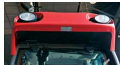
Klimatizácia uložená v zadnej časti strechy bez obmedzenia výhľadu s integrovanými pracovnými svetlami.
