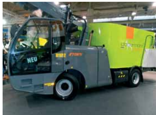
Taliansky výrobca strojov určených do živočíšnej výroby predviedol inovovaný samochoďný krmný voz s vertikálnym miešaním DOBERMANN EVO, osadený novým motorom Deutz s filtrom pevných častíc a zbernicou ISO BUS.
