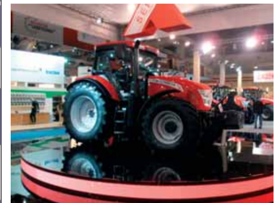
McCORMICK s novým radom X7 vybaveným plynulou prevodovkou CVT (175- 190 HP) - 3 nové modely.
