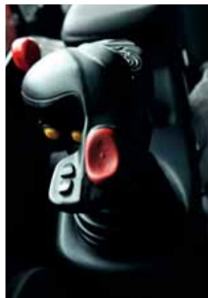
Ovládacia páka JSM s tlačidlami +/- pre radenie rýchlostí, pojazdu dopredu/dozadu a všetkých pohybov ramena a príslušenstva.
