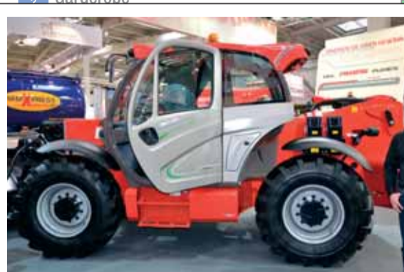
Novinka pre veľké farmy, bioplynové stanice, odpadové hospodárstvo - MANITOU MLT 960, s dosahom 9 m, nosnosťou až 6 t. Stroj je poháňaný 141 HP motorom, vybavený vario prevodovkou a jeho hmotnosť presahuje 11,5 t.
